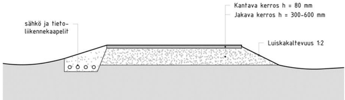
Periaatekuva uuden ja perusparannettavan tien rakenteesta.
